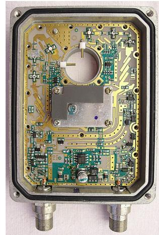
Bild 14.2.: LNB-PCB [27]
