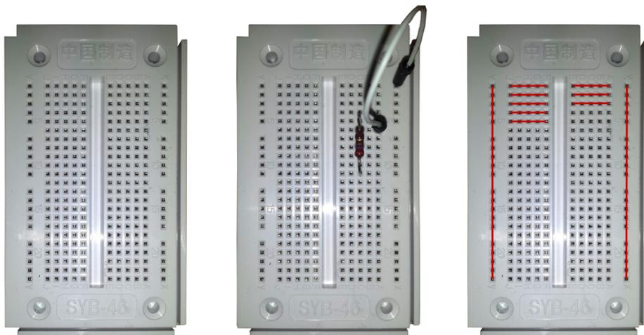
(a) Leeres Breadboard (b) Bestückt mit Bauteilen (c) Interne Verbindungen
